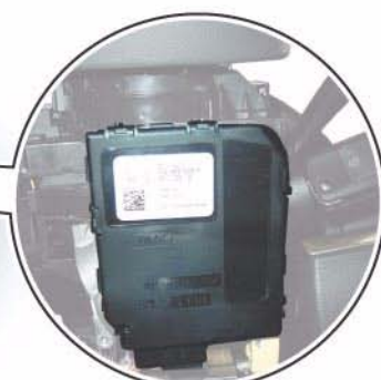
Блок управления рулевой колонки J527, в нижней части рулевого вала
