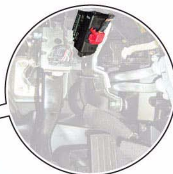
Диагностический интерфейс J533, под передней панелью, над педалью газа
